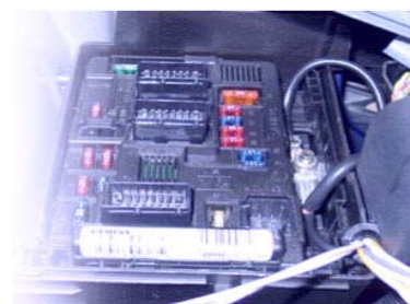
شکل ۲ : کامپیوتر مرکزی در سیستم مالتی پلکس (BSI)
